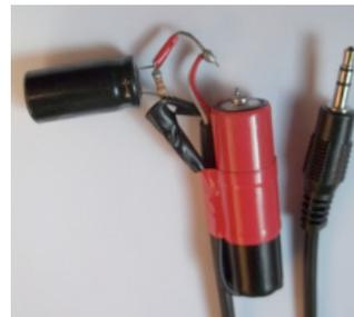
Cuando se deshace el contacto con el terminal positivo de la pila el Capacitor comienza a descargarse a través del Resistor.
