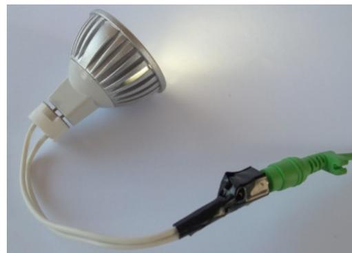
Para proteger los cargadores en forma sencilla y con componentes de bajo costo, se monta en serie a la salida del cargador una lámpara de 12V y 15 W (para XO1) o 12V y 21W (para XO1.5 y XO1.75): estas se consiguen fácilmente en plaza porque son de uso común en autos y/o motos.
