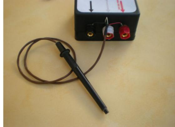
Los sensores resistivos (**SR**) que tienen dos terminales y no necesitan alimentación se conectan entre "OV" (negro) y "señal" (blanco): en la imagen inmediata superior izquierda se muestra como ejemplo un sensor de luz basado en un LDR.
