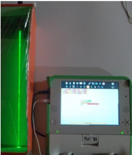
Una variante muy entretenida para los estudiantes consiste en iluminar el LDR mediante un puntero láser de tal forma que el programa de "bienvenida" se dispare cuando se interrumpe el haz. Incluso el puntero y el sensor pueden separarse gran distancia e interrumpir el haz mediante el paso de una persona entre ellos.
