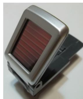
a. Debe iluminarse la celda con luz proveniente de una fuente luminosa de intensidad constante como el sol o una lámpara incandescente alimentada por DC. En este caso se utilizó una lámpara de 12V y 10W alimentada por el cargador de XO1 ( $12V$  y  $P_{m\acute{a}x} = 17W$ ):
